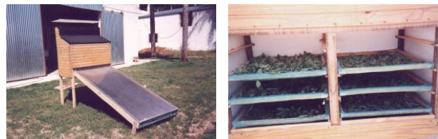
Figura 5: Vista del secadero solar y detalle del interior de la cámara de secado.
