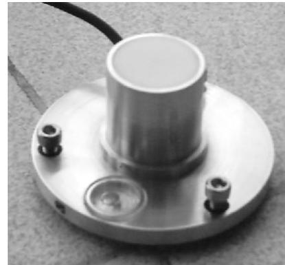
Figura 2.- Foto del Piranómetro fotovoltaico construido.
