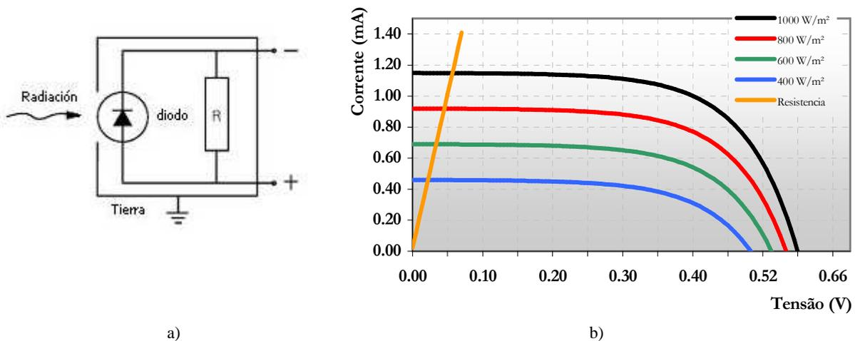
Figura 3.- a) Esquema de conexión de la resistencia *shunt*. b) Gráfico, no representativo del sensor utilizado, que muestra la proporcionalidad de la caída de tensión en el *shunt* respecto a distintos niveles de radiación en un dispositivo fotovoltaico (Prieb, 2002).
