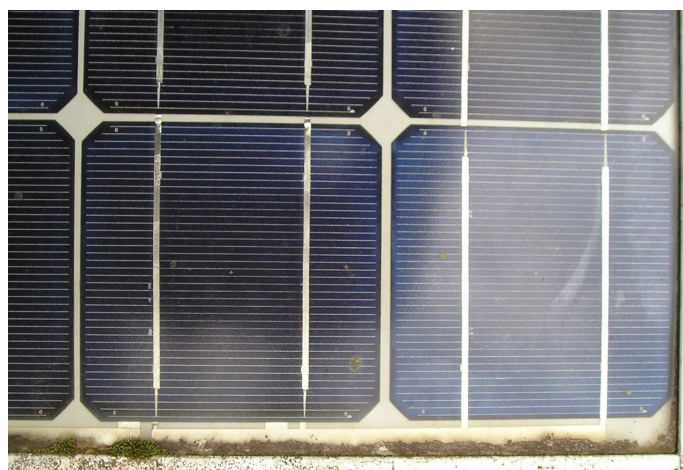
Figura 3. Detalhe mostrando o acúmulo de sujeira na borda inferior de um dos módulos analisados.
