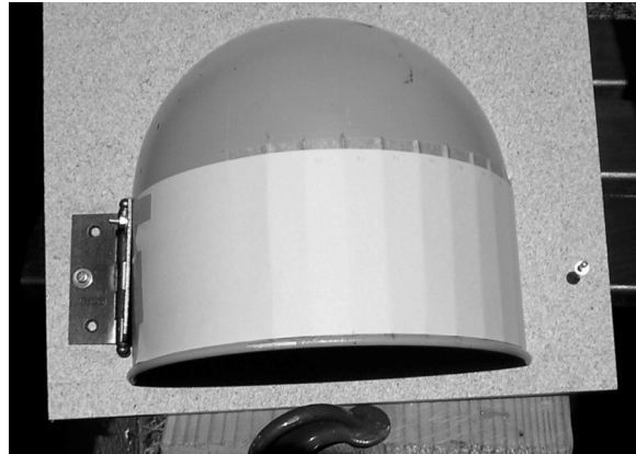
Figura 4.- Dispositivo utilizado para verificar a correspondência entre valores captados na superfície cinza de referencia e o co-seno de igual ângulo.
