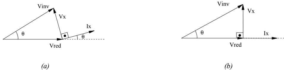
Figura 2: (a) Diagrama fasorial de tensión del inversor, tensión de red y corriente suministrada por el inversor, inyección de potencia activa y reactiva. (b) Diagrama fasorial de tensión del inversor, tensión de red y corriente suministrada por el inversor, inyección de potencia activa únicamente.
